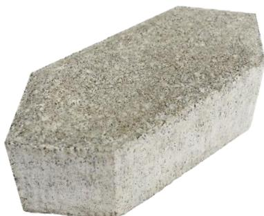
El adoquín Mediterráneo es un elemento macizo, prefabricado, con forma de prisma recto, con un ancho de 11 centímetros, un largo de 26.2 centímetros y un espesor uniforme de 8 centímetros.
