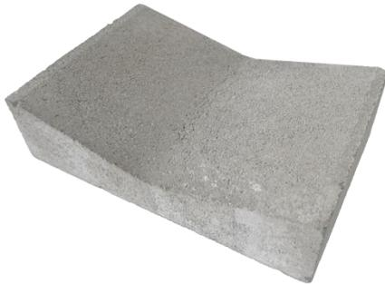
La canaleta Inclclinada es un elemento macizo prefabricado, su sección transversal tiene la forma de una "V" abierta, donde cada uno de sus lados en su superficie tiene una longitud de 28.26 centímetros y en cada uno de sus extremos posee un extremo horizontal de 2.5 centímetros de longitud.
